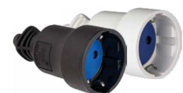
▲ Ficha T/TL 4,8mm Solera 16A - 250V IP44 Fixa cabos abatível Duplo sistema de terra Borracha preta Ref. 41990 PVC branco Ref. 41991
