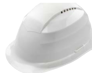
▲ Capacete de proteção branco Wolfcraft Resistente a quedas de objetos, impactos mecânicos e objetos pontiagudos e afiados Fácil de ajustar tamanho de 53 a 62cm Com pala para evacuação da chuva Ref. 82647
