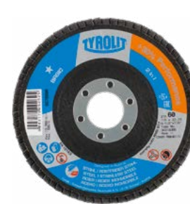
▲ Disco de lamelas Tyrolit Ø115 Para desbastar Para aço e para inox Grão 40 Ref. 82000 Grão 60 Ref. 82001
